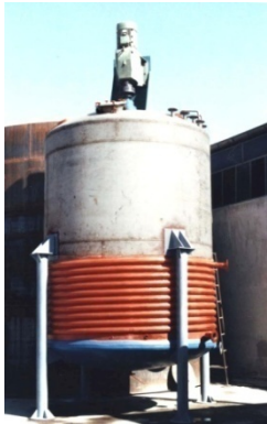
راکتورهای صنعتی با کویل داخلی یا خارجی از نوع مارپیچی Industrial Reactors With Internal Or External Heat Exchangers In Spiral Types
